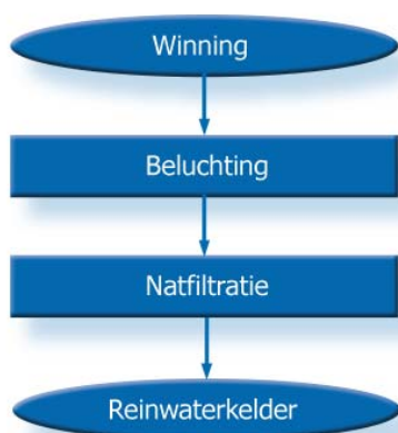
Figuur 21: zuivering van anaeroob grondwater.
