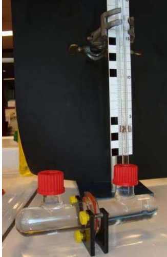
Figuur 8: osmosekamer met stijgbuis.
